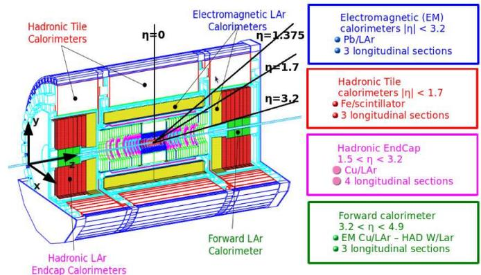
FIGURE 2.1 – Description des calorimètres dans ATLAS
