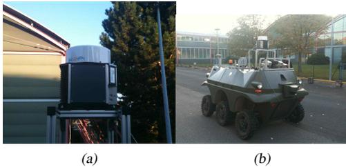
FIGURE 3 – (a) Le radar panoramique K2Pi. (b) Un des véhicules du projet IMPALA équipé du capteur.
