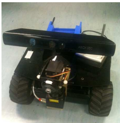
Figure 6 : Le robot Thumblar embarquant une Kinect.
