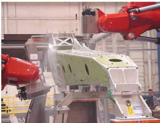
Figure 3-1 : Usinage de pièces préformées avec machine-outil à structure parallèle
