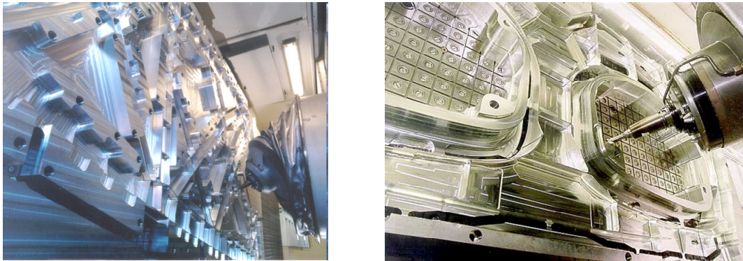
Figure 5-1 : Exemples d'usinage de pièces de structure avec machine-outil à structure parallèle
