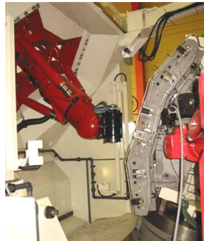
Figure 3-1 : Usinage de pièces préformées avec machine-outil à structure parallèle
