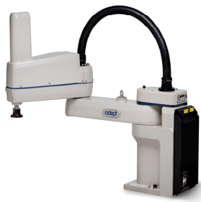
(a) Adept Cobra S800 Temps de cycle 25/305/25 : 0,54 s
