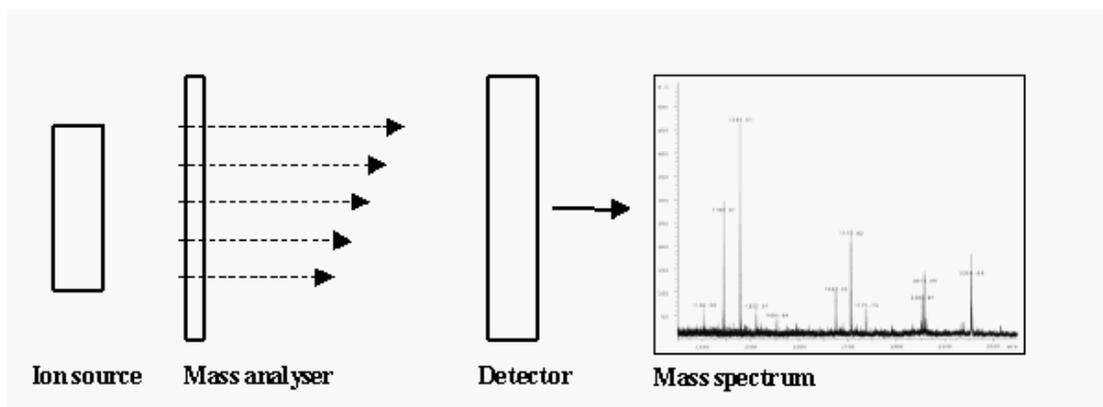
Fig 28: schéma général de la spectrométrie de masse
