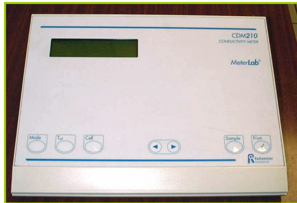
(Figure II-15) : Conductimètre CDM210 équipé d'une cellule de conductivité (CDC745-9) à 2 pôles (conductivités < 100 mS/cm).
