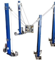
Fig. 1. The LIRMM/Tecnalia ReelAx8 robot
