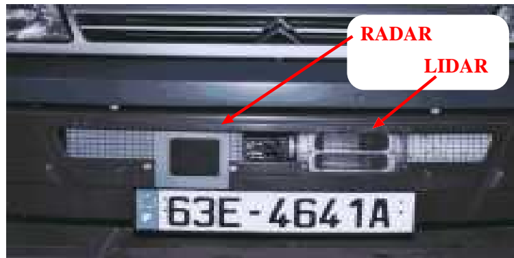
FIG. C.9: Radar et Lidar placés dans le pare-chocs
