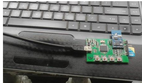
Gambar 3.7. Instalasi IQRF coordinator
