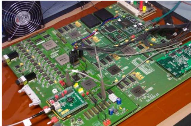
FIG. 5.33 – Prototype de l'unité de décision inséré sur une carte TELL1.
