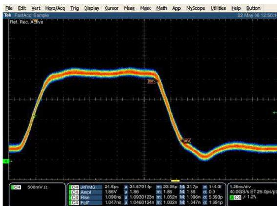
FIG. 6.11 – Mesure de la variation de la phase en entrée d'un désérialiseur.
