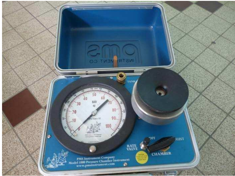
Figure 4 : Chambre à pression de Scholander (Photo : Noémie Gaudio)
