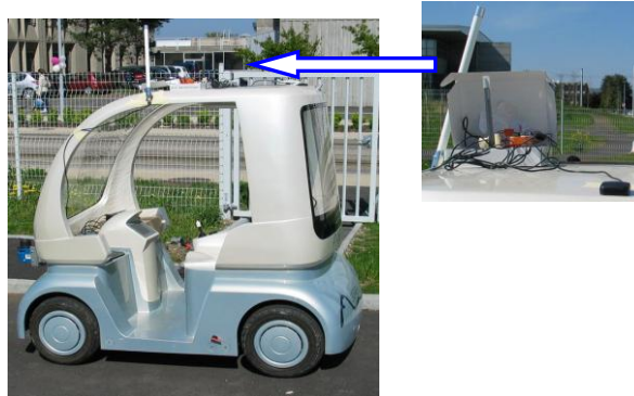
Figure III- 37 Un Cycab avec un LiveNode
