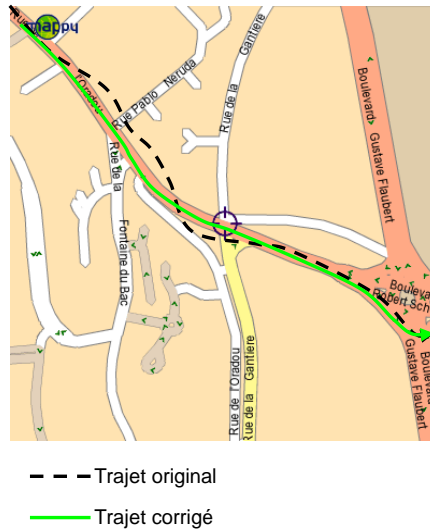
Figure III- 8 Correction à l'aide d'une carte numérique (MAP MATCHING)
