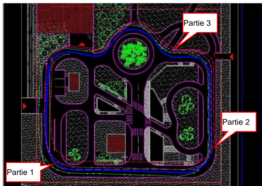
Figure III- 43 PAVIN- trace d'un mobile avec 3 récepteur GPS
