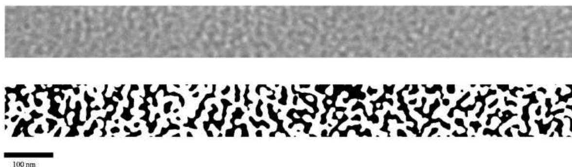
Figure 7. Morphologie d'une section de la couche active P3HT / PC 60 BM d'une cellule à hétérojonction volumique : (Haut) cliché MET ; (Bas) image binaire de ce cliché [70]
