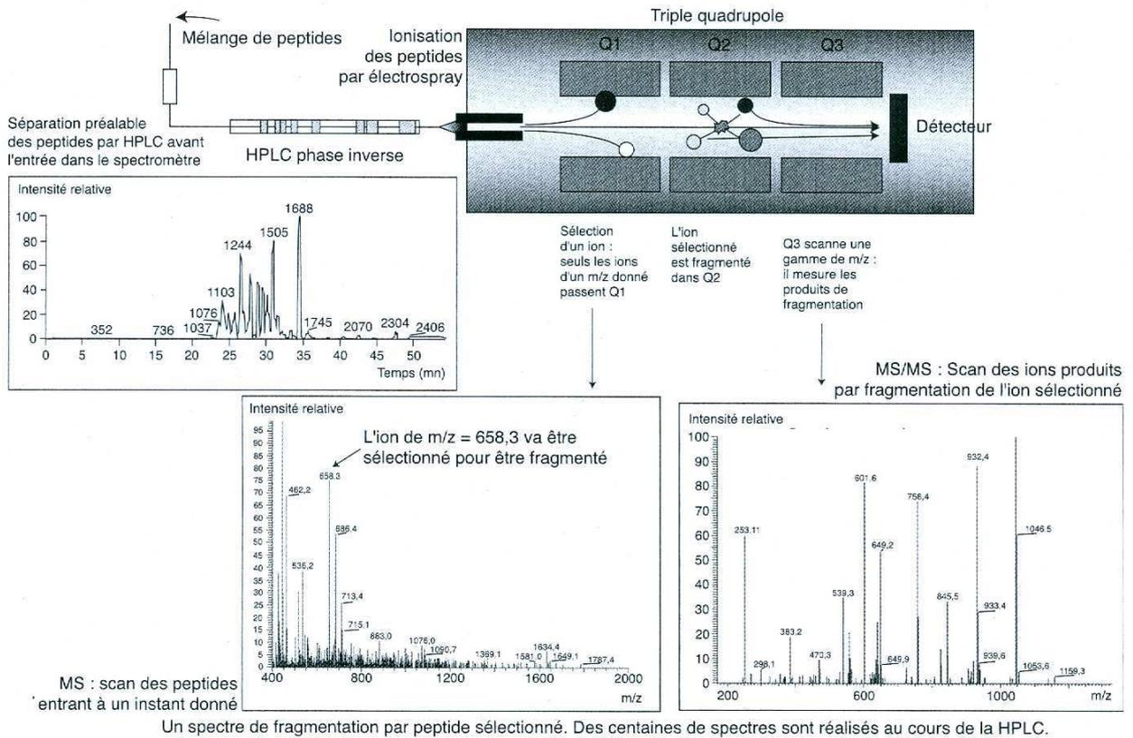
Figure 7: Fonctionnement du couplage LC-MS/MS (Zivy et al., 2004)
