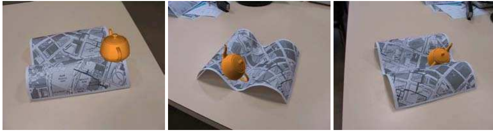
FIGURE 5.25 – Exemple de réalité augmentée. Le surface estimée de la feuille est utilisée pour incruster une théière évoluant sur la feuille.
