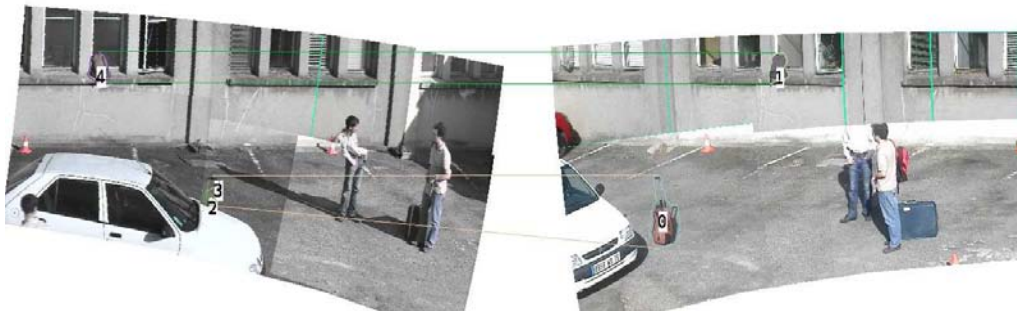
FIGURE 3.11 – Séquence extérieur 2 . Détection d’un objet fortement occulté. Notre méthode permet de détecter l’occultation et de corriger l’estimation de l’altitude et la taille de l’objet.
