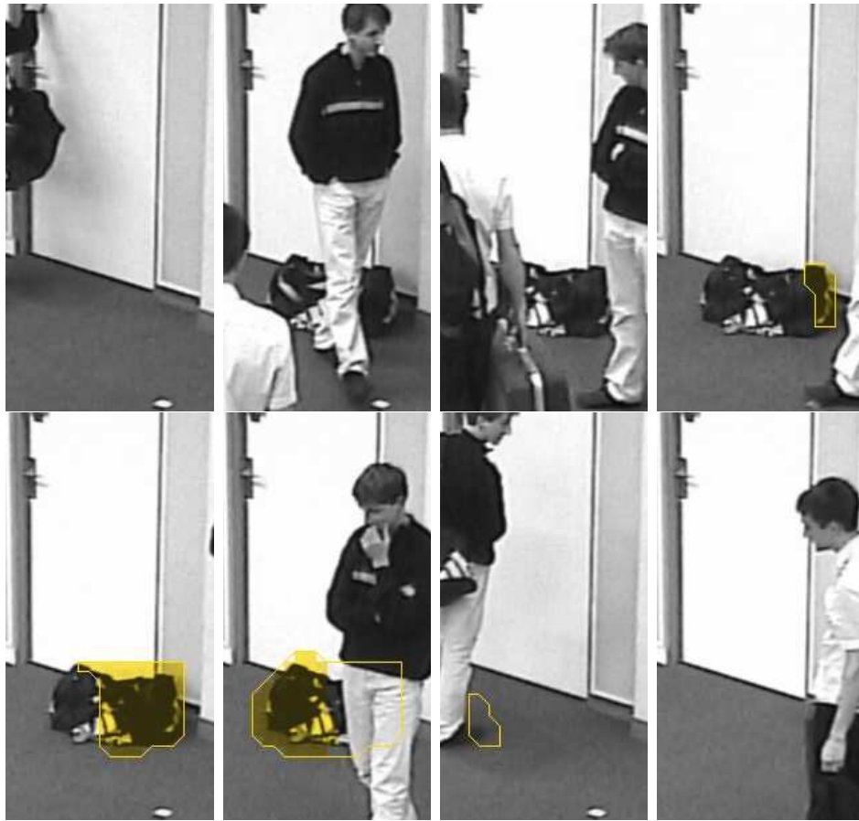
FIGURE 2.6 – Détection d'un objet stationnaire qui apparaît sous occultation partielle. La figure 2.7 montre la même scène filmée sous un autre point de vue.
