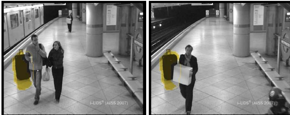
FIGURE 1.18 – Objet stationnaire détecté partiellement occulté. Un masque binaire permet de conserver en mémoire les blocs qui ont été détectés comme stationnaires et donc de préserver la forme des objets stationnaires même lorsqu'ils sont occultés. Un pixel du masque n'est remis à zéro que si le fond est de nouveau observé.
