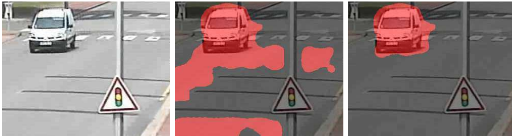
FIGURE 1.8 – Bien que peu visibles les artefacts JPEG peuvent causer des faux positifs sur les régions les plus homogènes de la scène. En effet le descripteur SURF est normalisé et donne trop d'importance au bruit dans les zones peu texturées. Gauche : Image originale. Milieu : Détection sans correction de la norme. Droite : Détection attendue avec correction.
