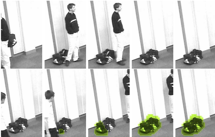
FIGURE 2.7 – Détection d'un objet stationnaire qui apparaît sous occultation partielle. La figure 2.6 montre la même scène filmée sous un autre point de vue.
