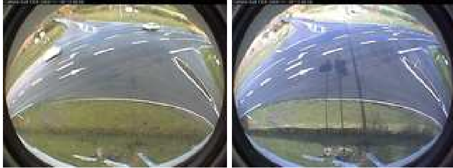
FIGURE 1.3 – Exemple de changement brusque de luminosité entre deux images consécutives à un faible taux de rafraîchissement.
