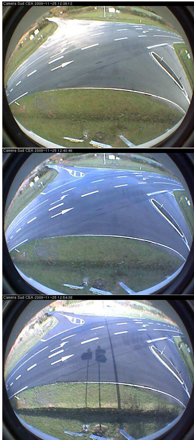
FIGURE 1.2 – Trois exemples d'une même scène sous des conditions très différentes de luminosité. On peut noter la présence de spécularité sur la route due à la pluie, de fortes ombres portées au sol, une importante saturation en cas de luminosité trop forte et une importante variation de la teinte.
