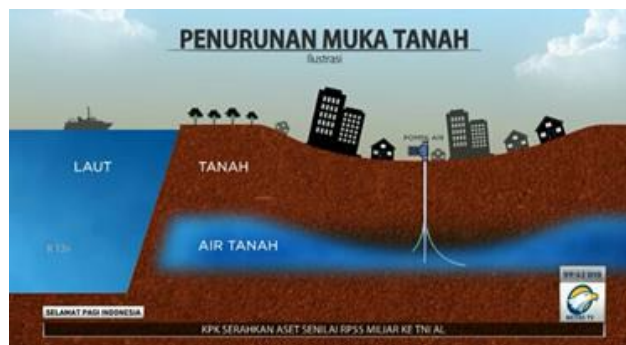
Sumber : m.metrotvnews.com Gambar 4 Penurunan Akibat Sumur Dalam
