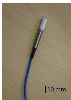
Figure IV-4 : Diode E de PTW (PTW Freiburg, Freiburg, Germany), modèle T60012.
