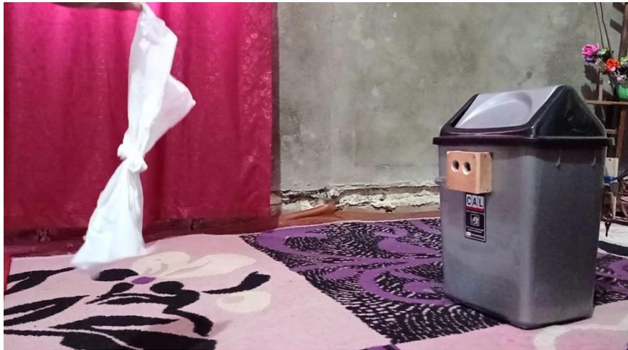
Gambar 4.7 Pengujian tempat sampah otomatis dengan tisu
