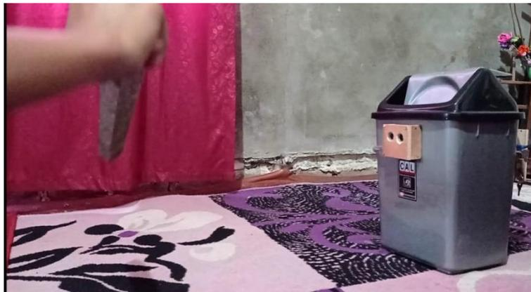
Gambar 4.2 Pengujian tempat sampah otomatis dengan kayu
