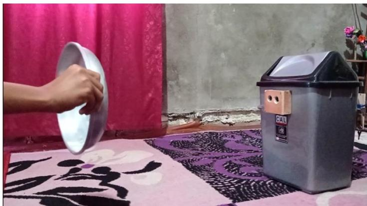
Gambar 4.3 Pengujian tempat sampah otomatis dengan besi
