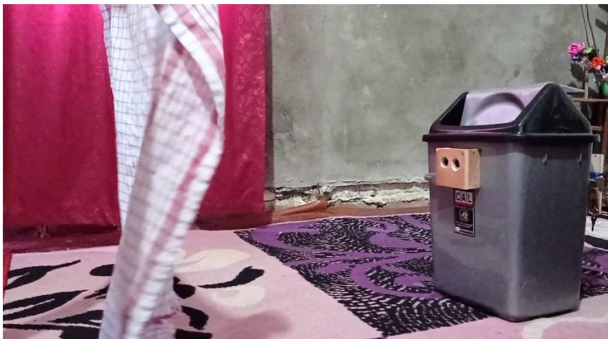
Gambar 4.6 Pengujian tempat sampah otomatis dengan kain
