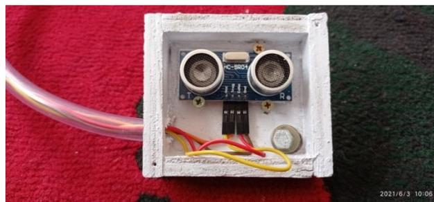
Gambar 3.14 Sensor Ultrasonik terpasang pada pelindung alat 2
