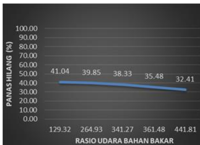
Gambar 8. Grafik Hubungan Rasio udara/BB Terhadap Kehilangan Panas (%)
