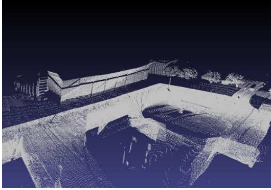
FIGURE 1 – Nuage de points 3D obtenu à partir des données de incl-laser et de la trajectoire obtenue par odométrie pour le début de la séquence CEZEAUX-Sealiz
