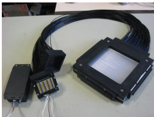
Figure 5 : prototype d'hodoscope 2x128 fibres, avec photomultiplicateur multivoies
