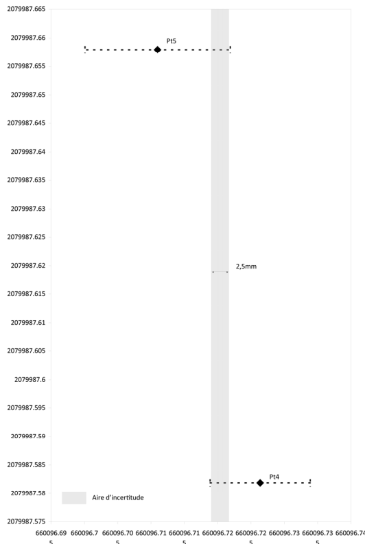
Figure A.2.7 – spatialisation des positions moyennes des points 4 et 5, dans l'intervalle de confiance 3\sigma (99,7% de confiance) – en grisé, l'aire d'incertitude
