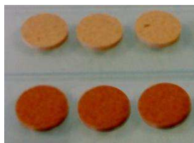
Figure II-8 – Pastilles de farine de bois non-traitée (haut) et fluorée (bas)
