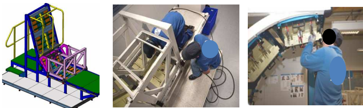
Fig. 2 Représentation 3D d'un bâti d'entraînement et situation de formation sur bâti en salle Training
