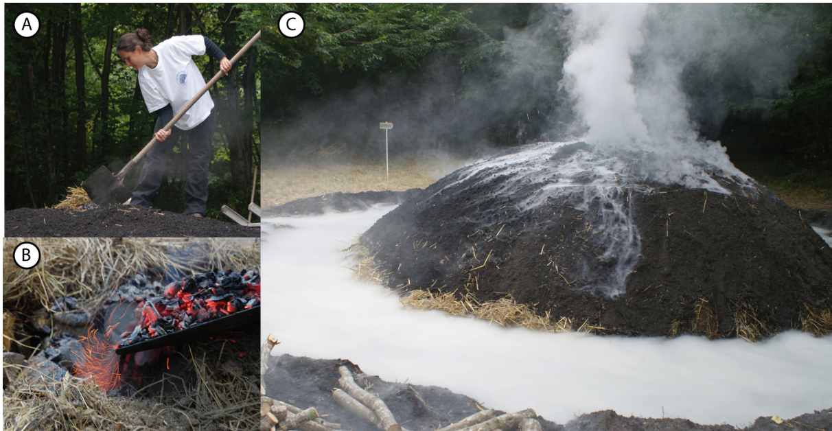
Figure 29 : Allumage de la meule par dépôt de braises au fond de la cheminée (A , B) et début de carbonisation (C) (Cliché S. Paradis-Grenouillet et R. Rouaud)
