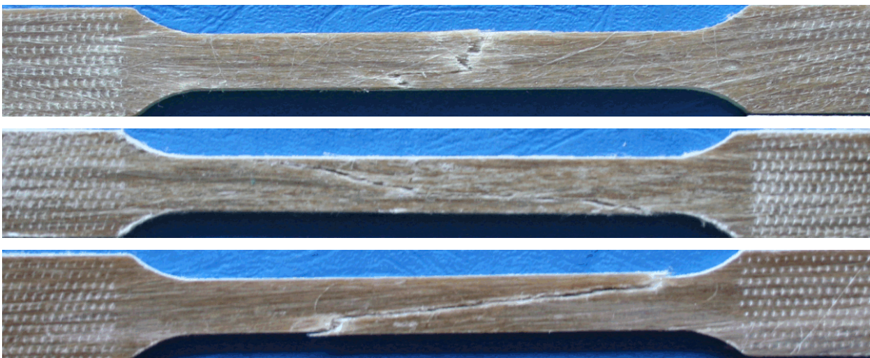
Fig. 4 - 16. Photographies d'éprouvettes de composites fabriqués par compression et sollicités en tension jusqu'à rupture
