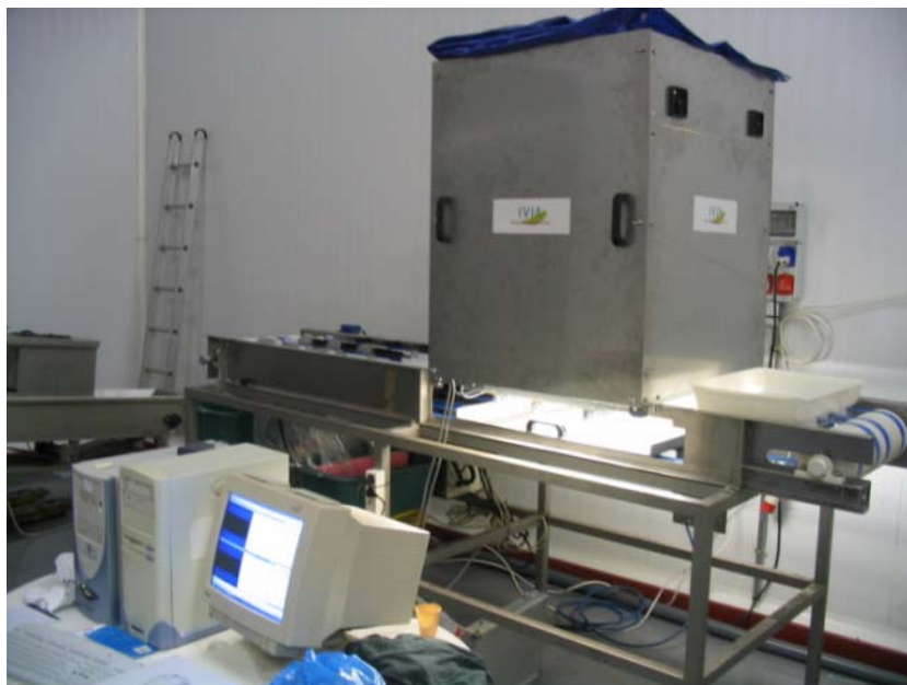
Figura 7. Prototipo para la inspección de granos de granada
