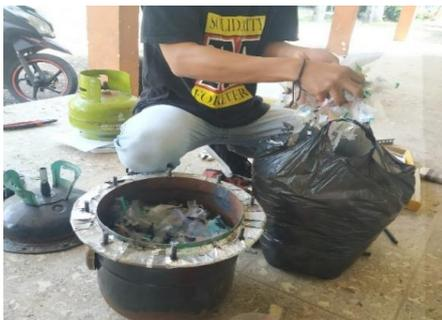
Gambar 3. Bahan bakar didalam Tabung Reaktor
