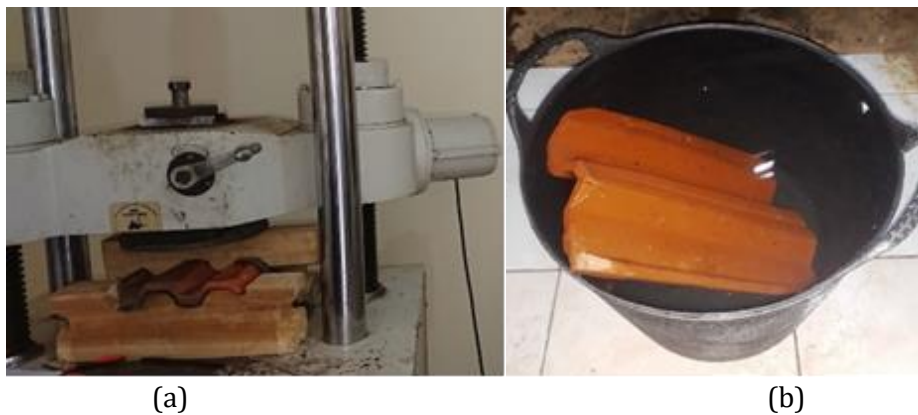
Gambar 4. (a) Proses pengujian kekuatan tekan dan (b) penyerapan air
