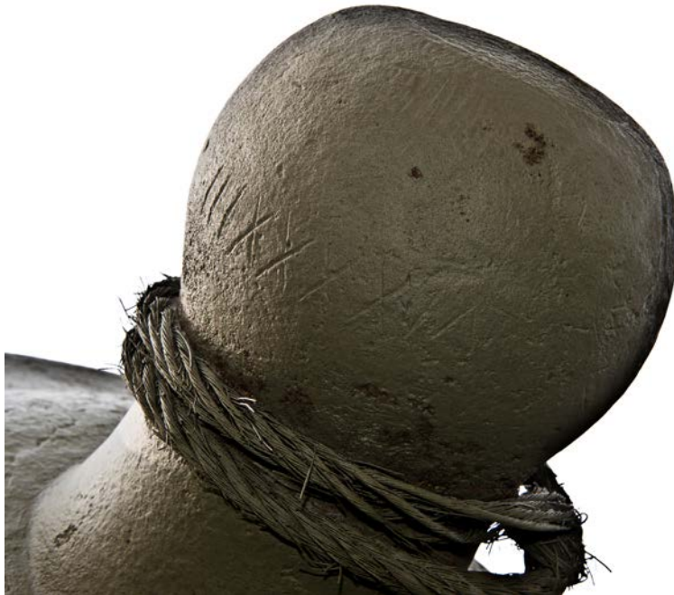
15 De druif met daarop aangebrachte gelegenheidsmerken en resten van een staaldraadstrop
