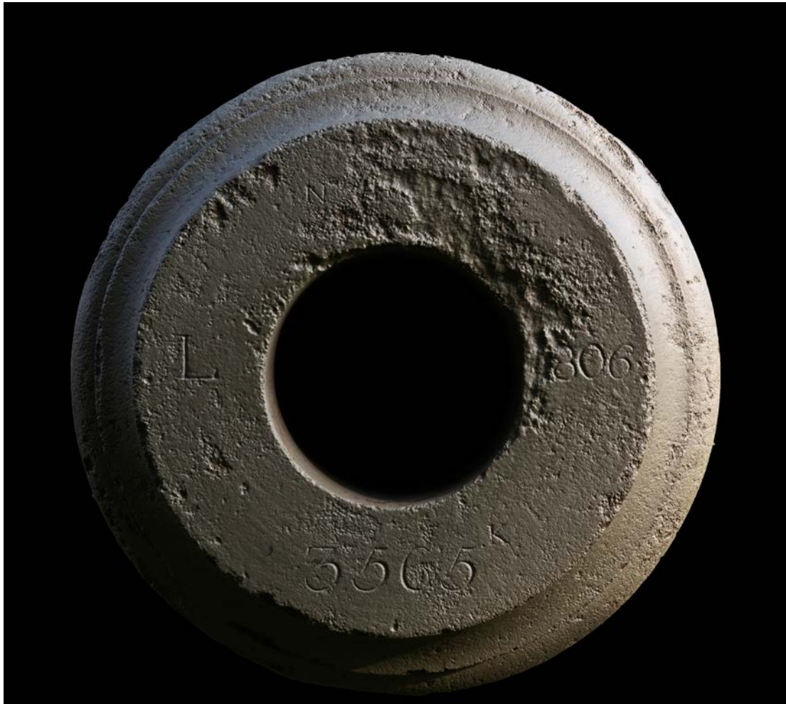
13 Het mondingsvlak met merktekens L (=Luik), het jaartal 1806, het gewicht 3565 K (kilo)en (bovenop) een merkteken beginnend met N (?)
