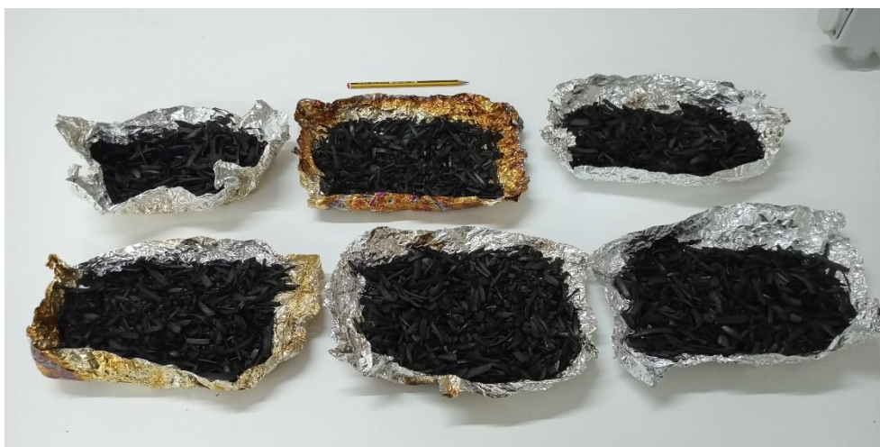
Figura 9 - Arrefecimento dos pacotes de alumínio de um lote após produção de biochar em mufla.
