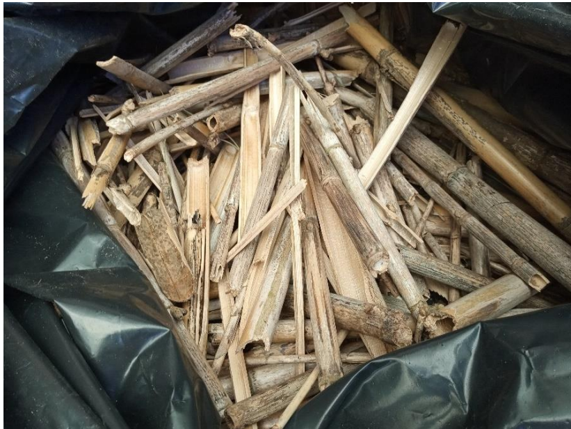
Figura 6 – A. donax após corte com serra de mão ( < 40 \text{ cm} de comprimento).
