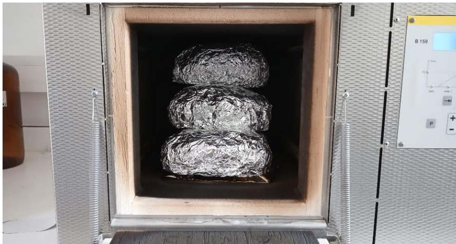
Figura 8 - Colocação de 6 pacotes de alumínio (lote) (6 x 100 g) na mufla para produção de biochar .
