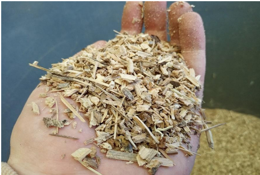
Figura 7 - Lascas de A. donax obtidas após secagem, trituração e crivagem com malha de 20 mm.
