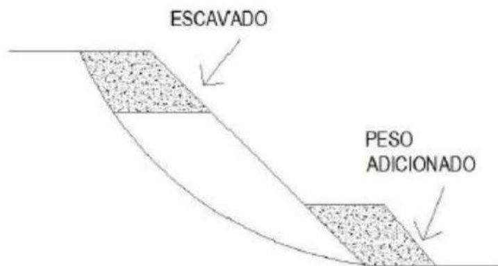
FIGURA 11 – ESCAVAÇÃO DE CRISTA E ATERRO DO SOPÉ; FONTE: OLIVEIRA, 2010
