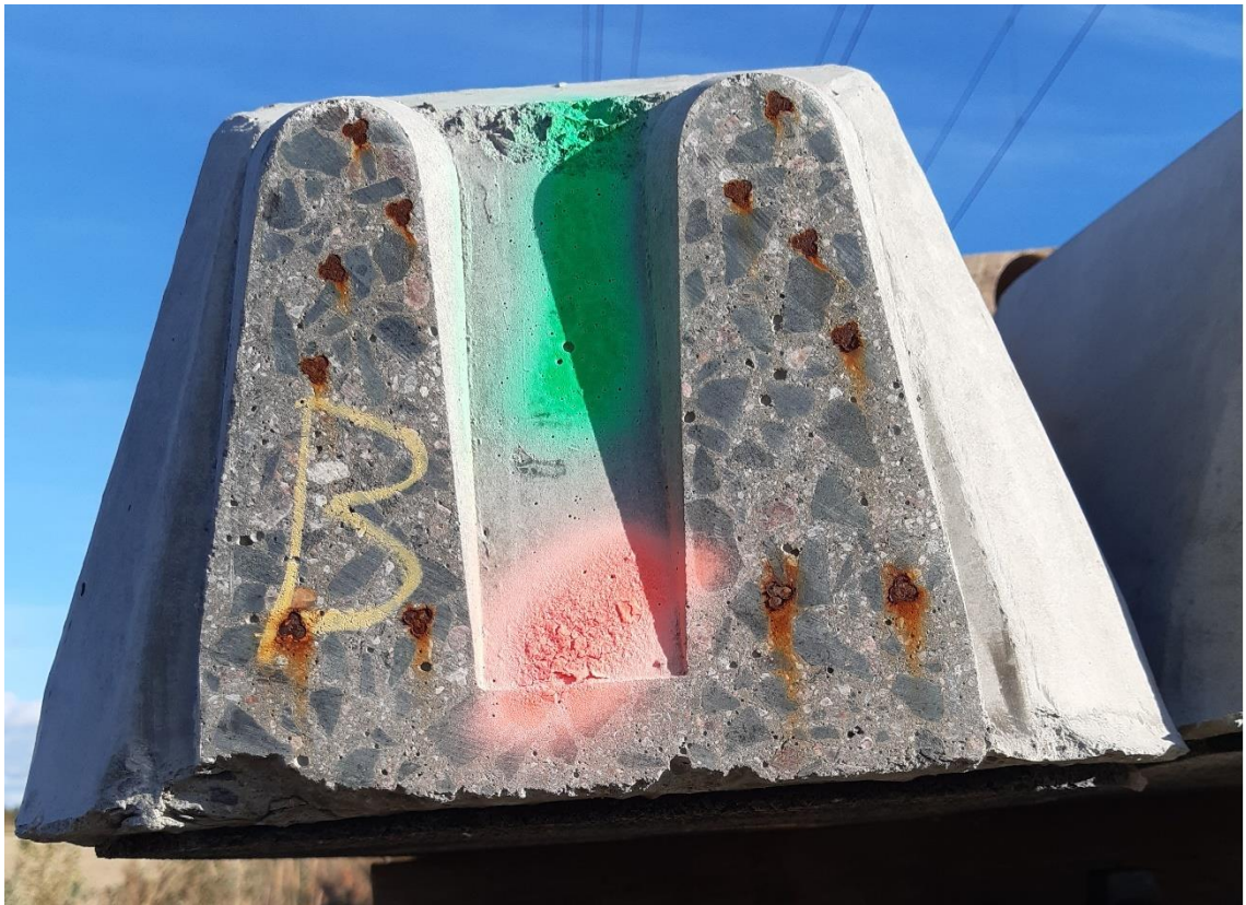
Kuva 11. Pohjaimella Pandrol USP-I-10b ja 60E1-kiskokiinnikkeillä varustetun pölkyn merkintä. Valokuva: Erno Oikarinen.
