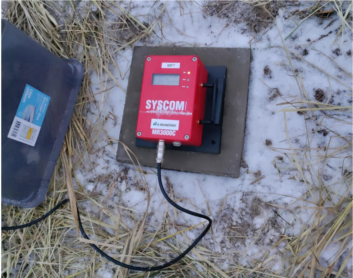
Kuva 10. Maaperän värinämittauksissa Pori-Mäntyluodossa joulukuussa 2021 käytetty mittalaite. Valokuva: Erno Oikarinen.
