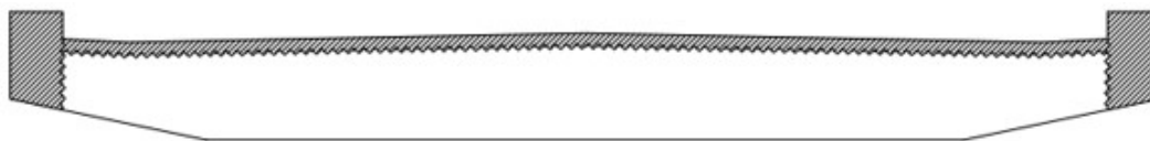
Kuva 1. Laattasilian pintavaluvahventaminen, periaatekuva (Betonisiltojen korjaus- ja vahventamissuunnitteluohje luonnosversio 12/2021, s. 78)
