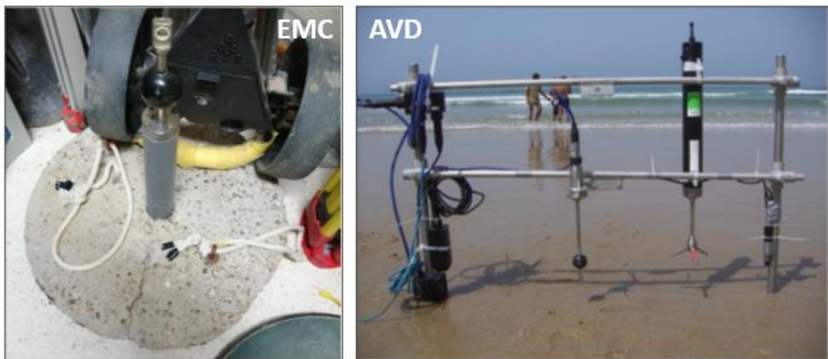
Figura 5. Colocación del sensor de presión en el muerto de fondeo (izquierda) y estructura de fijación de correntímetro AVD.
