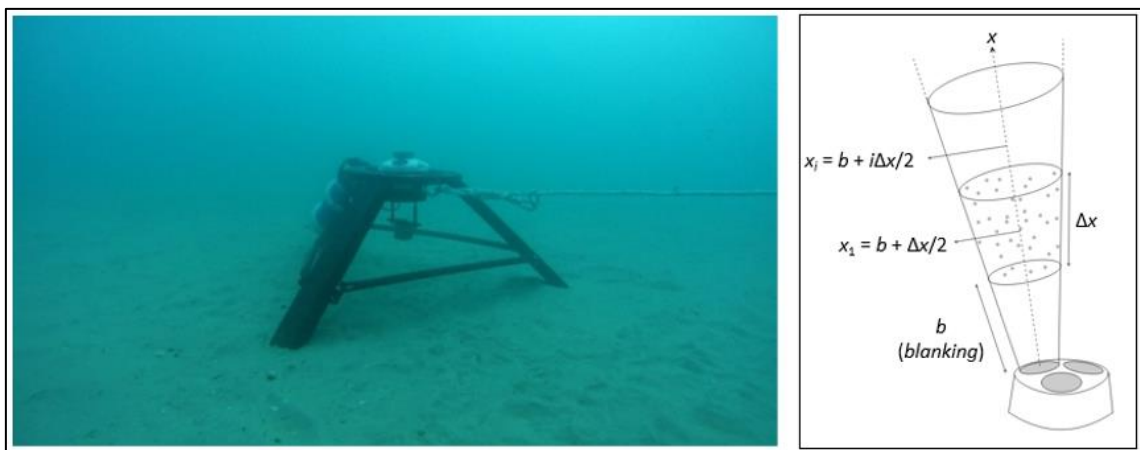
Figura 4. Correntímetro AWAC fondeado en la campaña 1 y esquema de medición.
