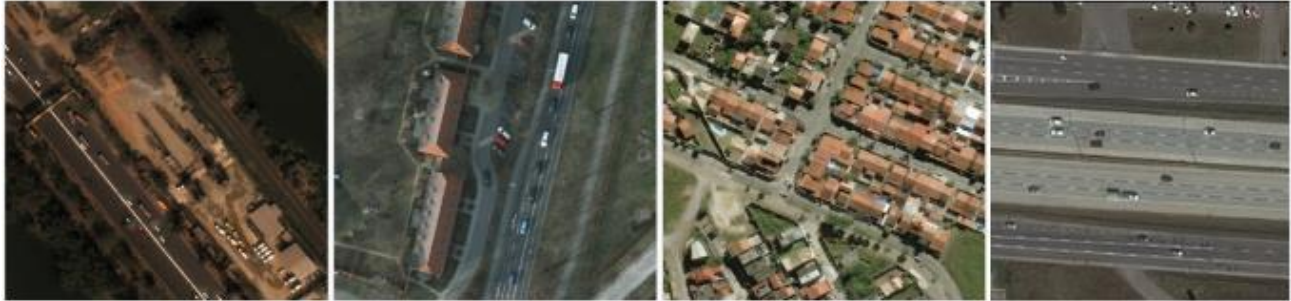
Figure 8 : Images de xView, COWC, SpaceNet et GeoImageNet respectivement. On y voit des différences de points de vue, d’angle solaire et de conditions d’éclairage. Les images ont aussi différentes résolutions spatiales : xView (30 cm), COWC (15 cm), SpaceNet (30 et 50 cm), GeoImageNet (50 cm) (Adapté de Lam et coll., 2018 )
