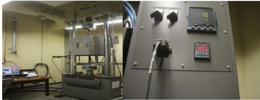
Figure 5.1 Machine MTS et contrôleur pour les essais SIM
