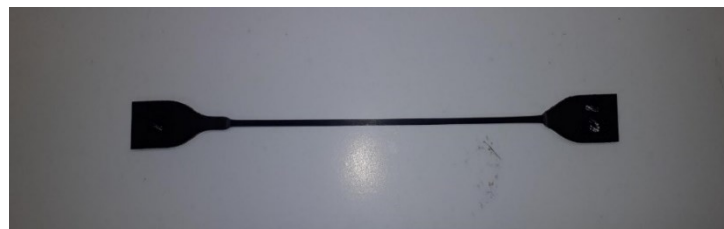
Figure 5.4 Mode de rupture typique des spécimens en PEHD après l'essai SIM
