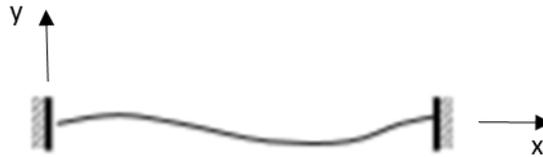
$$\text{fréquence propre de la corde, } f_i = \frac{i}{2L} \sqrt{\left(\frac{T}{m}\right)} \quad (A - 4.1)$$
