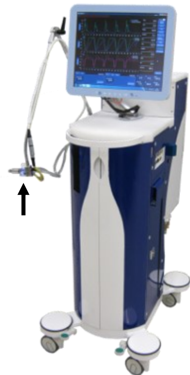
Figure 6: Prototype de ventilateur liquidien Inolivent-6. La flèche noire indique le connecteur en Y.
