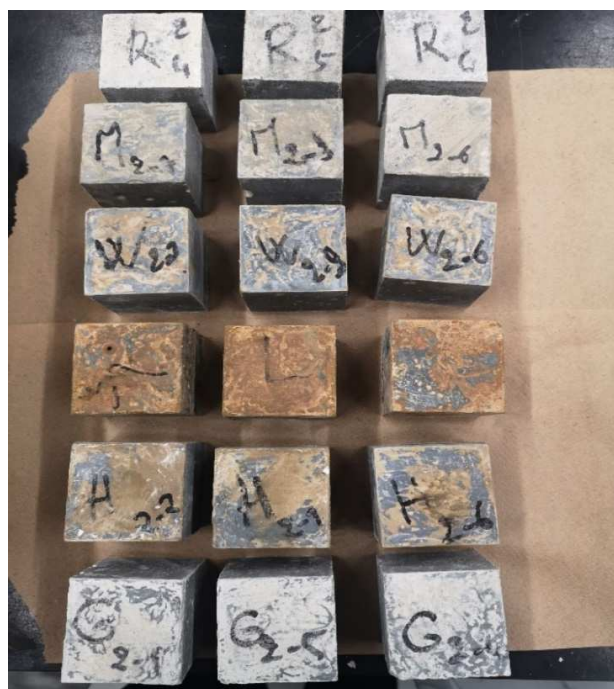
Figure 4-5 : Cubes de mortier oxydés
