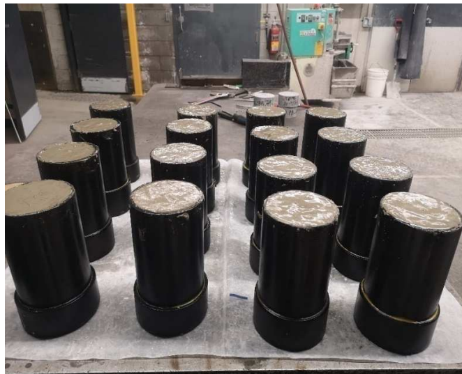
Figure 3-11 : Cylindres de béton coulés
