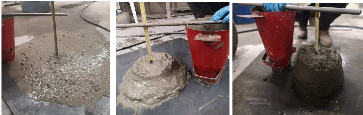
Figure 4-6 : Consistance très fluide (à gauche), fluide (au milieu) et plastique (à droite)
