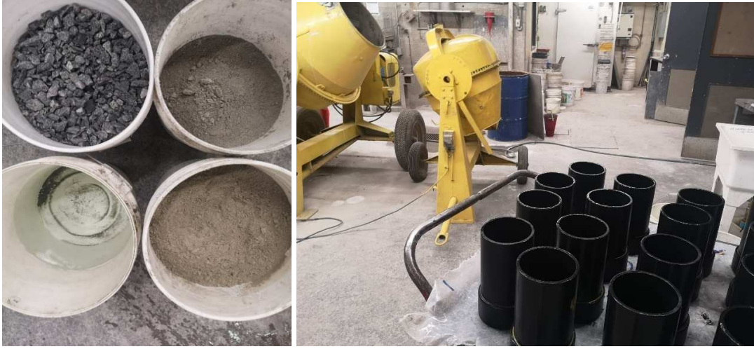
Figure 3-9 : Confection des cylindres de béton, dosage des ingrédients (à gauche) et préparation des cylindres et du malaxeur (à droite)
