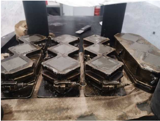
Figure 3-6 : Confection des cubes de mortier : moules cubiques (gauche) et cubes (droite)
