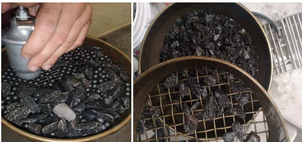
Figure 3-3 : Essai Micro-Deval sur les roches stériles concassées
