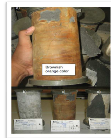
Figure 2-7 : Oxydation superficielle du mortier composite (Belem et al. 2010)
