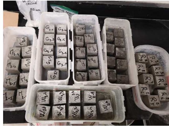
Figure 3-6 : Confection des cubes de mortier : moules cubiques (gauche) et cubes (droite)
