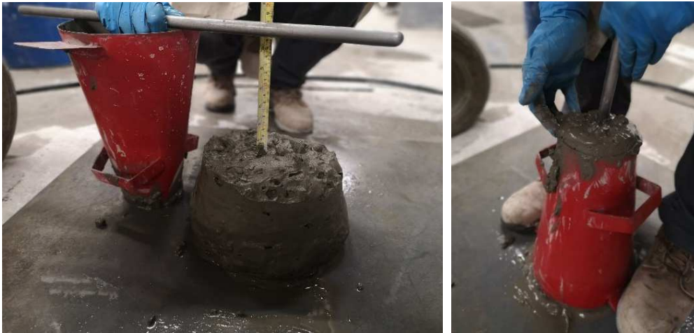
Figure 3-10 : Essai d'affaissement au cône Abrams
