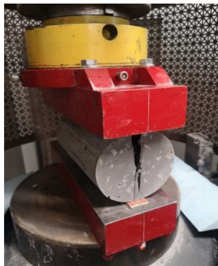
Figure 3-14 : Détermination de la résistance à la traction indirecte (Brésilien) sur des cylindres de béton
