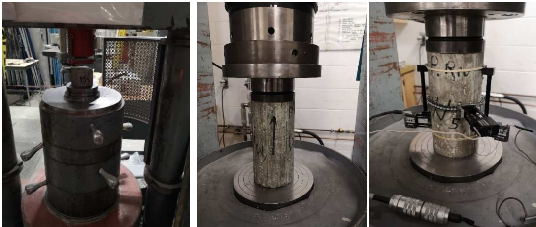
Figure 3-13 : Essai de compression uniaxiale sur un cube de mortier (à gauche), sur un cylindre de béton (au milieu) et essai de coefficient de poisson et module de Young (à droite)
