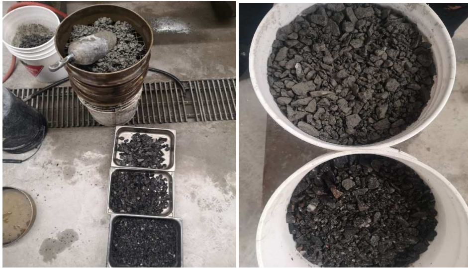
Figure 3-8 : Préparation des roches stériles concassées : tamisage (à gauche) et lavage (à droite)
