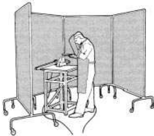
Mampara de protección
