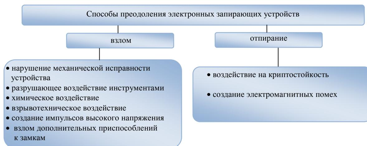
*Нарушение механической исправности* электронного запирающего устройства заключается в умышленном воздействии на конструктивные элементы запирающего устройства, обеспечивающие функционирование механической составляющей при наличии таковой. Такими элементами могут выступать ригель, ручка и др. Например, при деформации ригеля, зафиксировав его в положении «отперто», электронное запирающее устройство перестанет запирает дверь.
