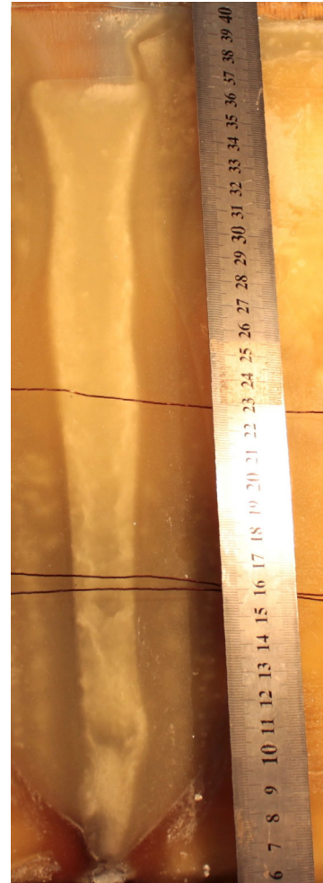
Рис. 6. Фотография канала плюма после затвердевания расплава ( N=5.9 Вт, l=12 мм).
