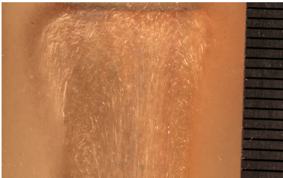
Рис. 7. Структура течения в верхней ячейке канала плюма, образующейся после прорыва плюма на поверхность слоя ( N=5.8 Вт, l=12 мм).
