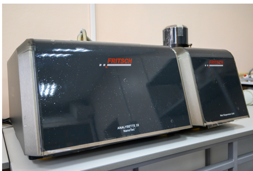
Рис. 10. Лазерный анализатор частиц Analysette 22 Nanotec (Fritsch, Германия). Предназначен для определения размеров частиц в рыхлых отложениях и техногенных продуктах.
