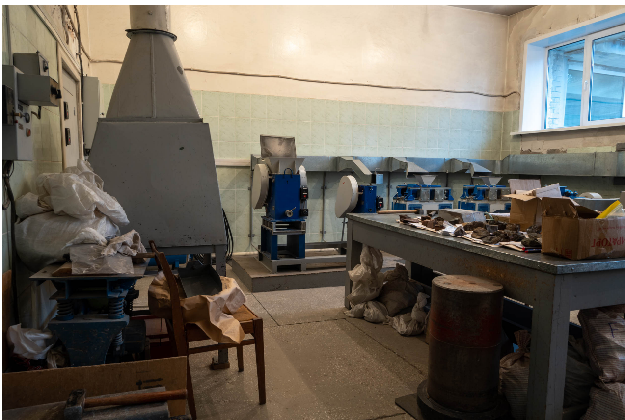
Рис. 9. Кабинет пробоподготовки, оборудованный дробилками и истрителями. Предназначен для первичной пробоподготовки горных пород.
