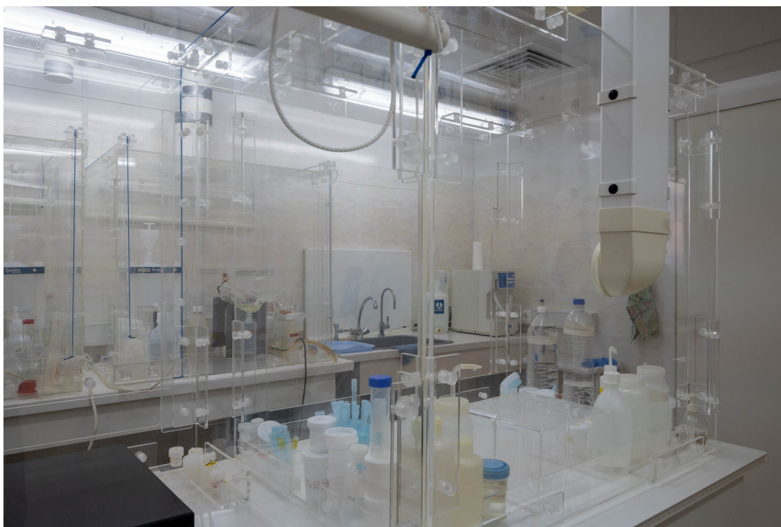
Рис. 3. Блок чистых комнат класса 1000 оригинальной конструкции. Предназначен для химпробоподготовки для изотопных исследований.
