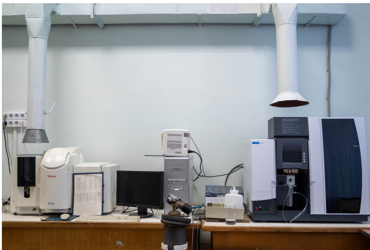
Рис. 4. Атомно-абсорбционные спектрометры: слева – Solaar M6 (Thermo Fisher Scientific, США), справа – 280FS (Agilent, США). Предназначены для силикатного анализа горных пород и для анализа природных вод.
