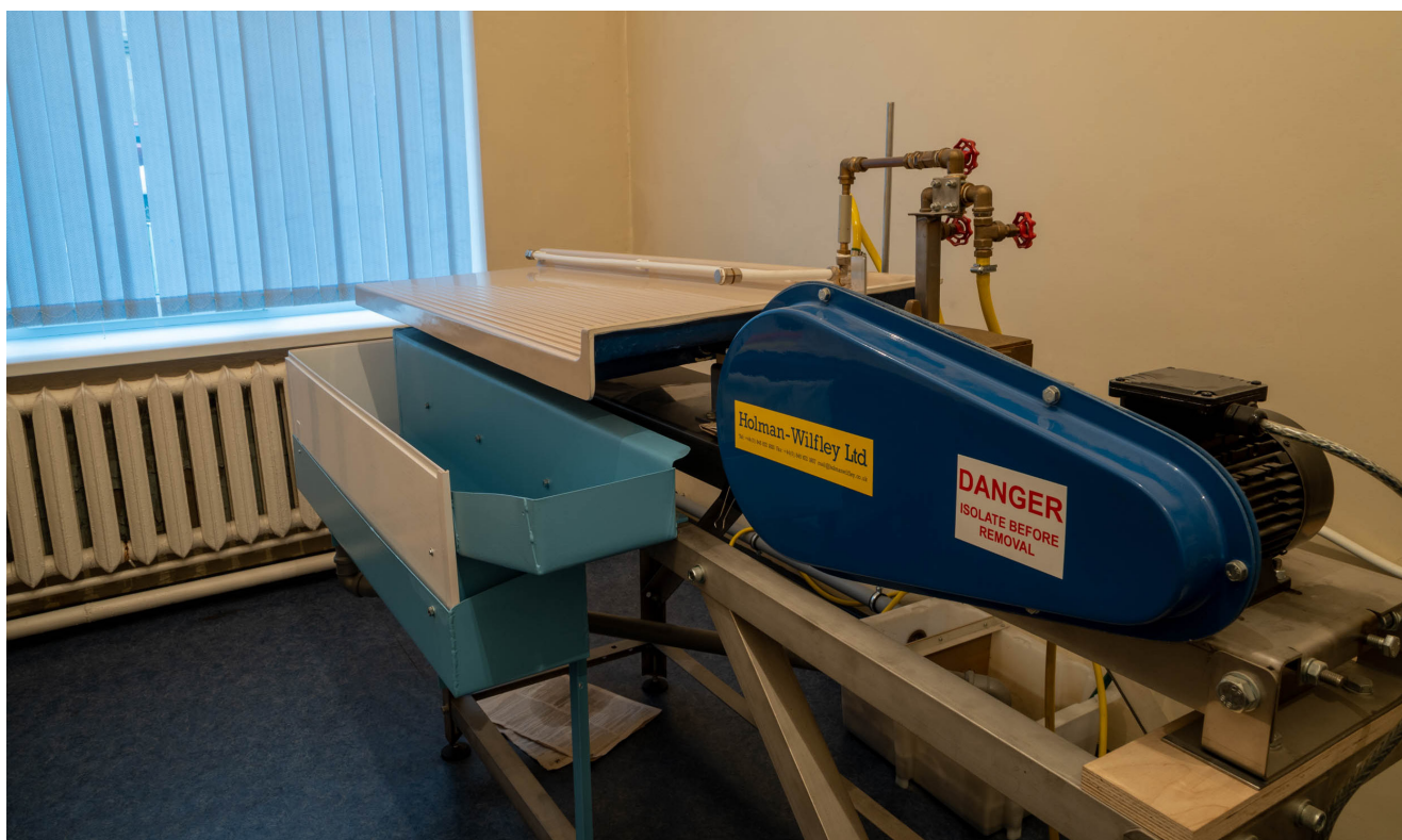
Рис. 8. Концентрационный стол Holman 8000 (Holman-Wilfley, Великобритания). Специализирован для выделения бадделейта. Fig. 8. Water-flow table Holman 8000 (Holman-Wilfley, Great Britain). Specialized for the isolation of baddeleyite grains.
