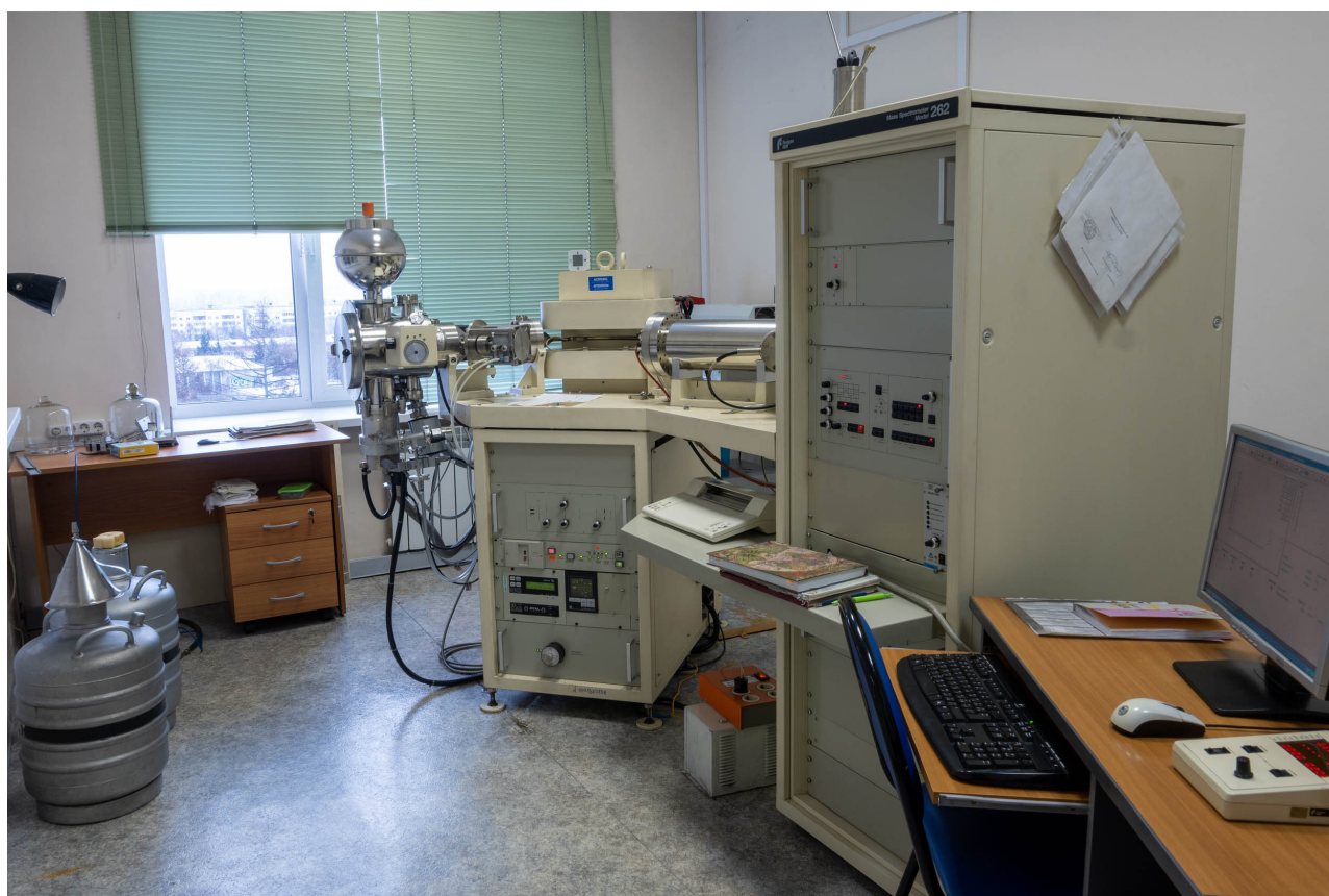
Рис. 2. Масс-спектрометр с термической ионизацией Finnigan MAT262 (Finnigan, Германия). Предназначен для прецизионных изотопных измерений элементов, в частности Rb, Sr, Sm, Nd, Pb и U.
