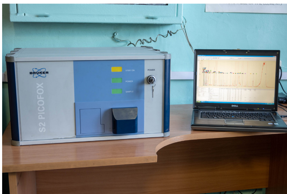
Рис. 6. Рентгенофлуоресцентный спектрометр с полным внешним отражением S2 PICOFOX (Bruker, Германия). Предназначен для определения содержаний основных и примесных элементов в малых количествах жидких и твердых образцов.
