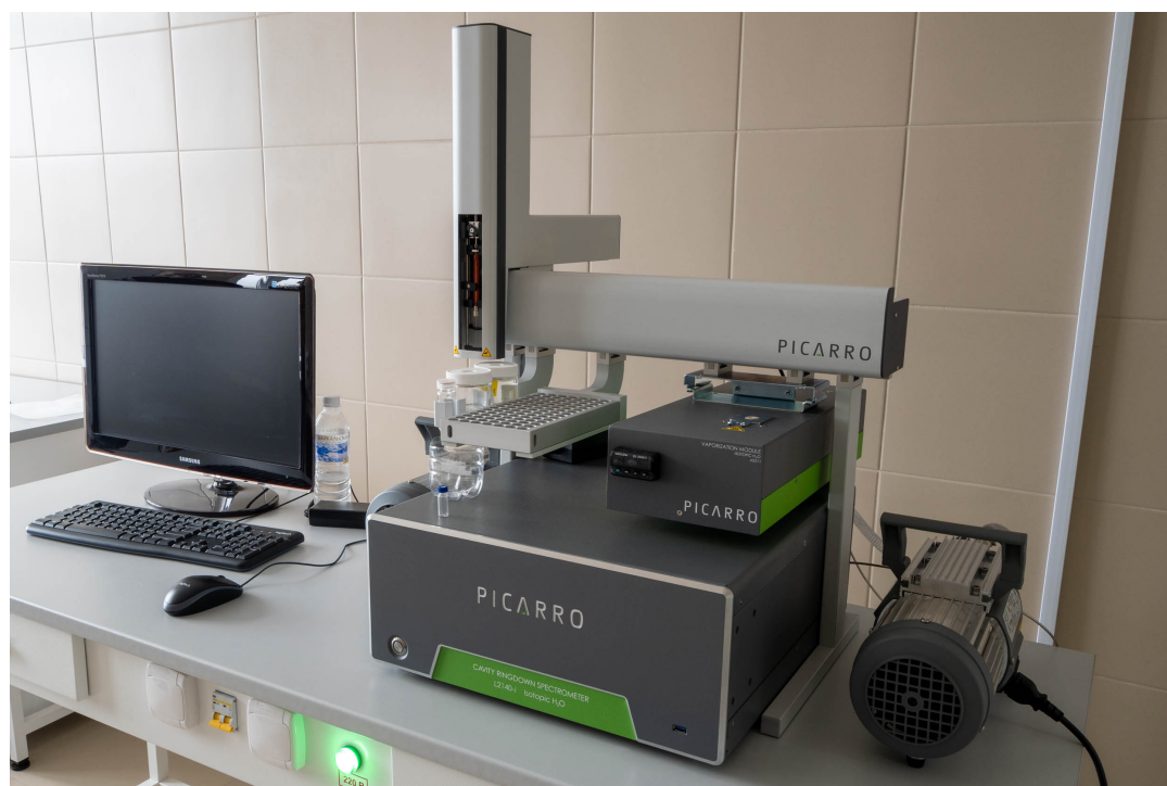
Рис. 11. Изотопный анализатор воды Picarro L2140-i (Picarro, США). Предназначен для определения \delta D , \delta^{17}O и \delta^{18}O в воде. Fig. 11. Cavity ring-down isotope analyzer Picarro L2140-i (Picarro, USA). Designed to determine \delta D , \delta^{17}O and \delta^{18}O in water.
