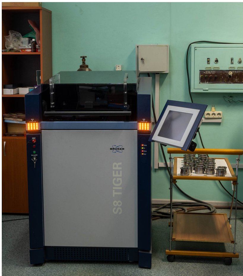
Рис. 7. Волнодисперсионный рентгенофлуоресцентный спектрометр S8 TIGER (Bruker, Германия). Предназначен для определения содержаний основных и примесных элементов в горных породах, почвах и других природных и искусственных средах.
