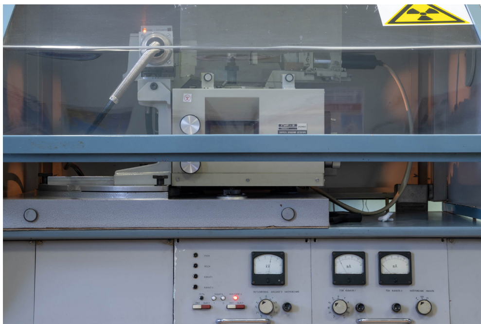
Рис. 1. Рентгеновский дифрактометр ДРОН-3 (Буревестник, Россия). Предназначен для определения кристаллических структур, установления фазового состава полиминеральных смесей, в частности глин.
