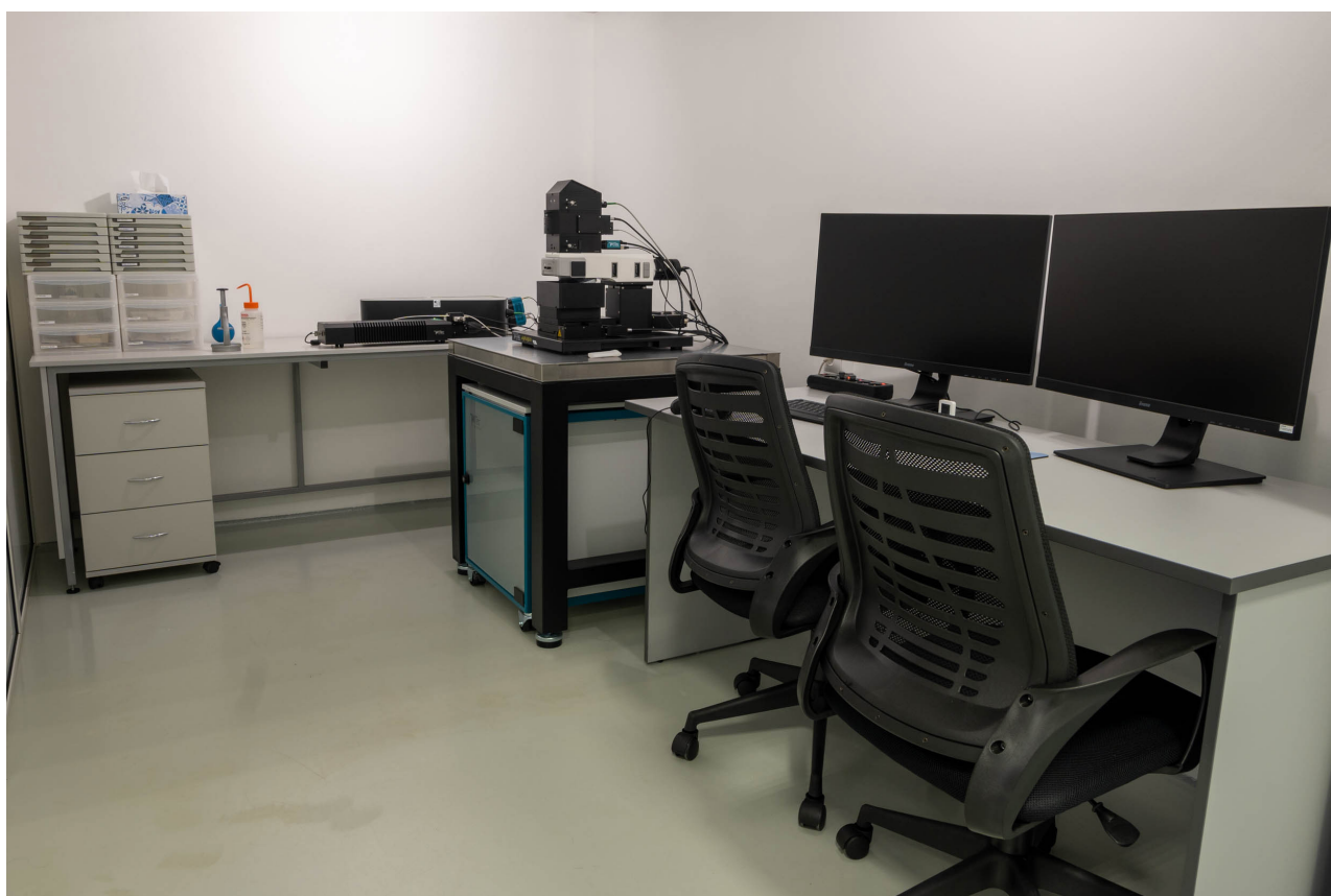
Рис. 12. Рамановский спектрометр WITec Alpha300 R (Witec, Германия). Предназначен для изучения вещества методом конфокальной Рамановской спектроскопии. Fig. 12. Raman spectrometer WITec Alpha300 R (Witec, Germany). Designed for the study of matter by the method of confocal Raman spectroscopy.
