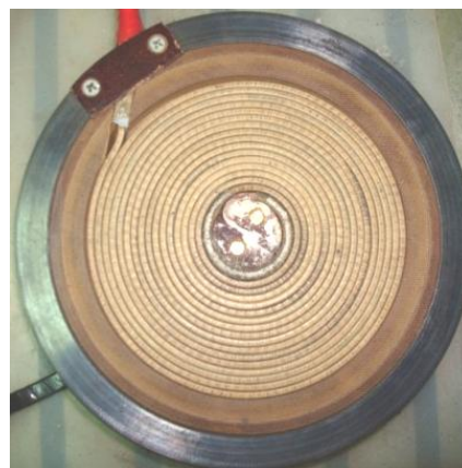
Рис. 2. Специальный индуктор для упрочнения плоских стальных изделий
