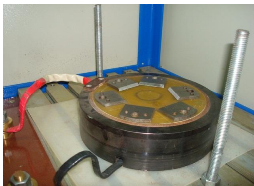
Рис. 3. Установка ножей на плоский индуктор
