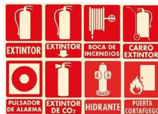
Figura 1: Señalización de los medios de protección contra incendios
