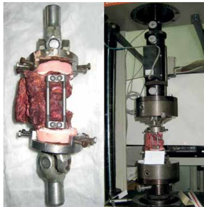
Рисунок 3. Анатомический препарат Th12-L2 с имитацией нестабильного повреждения Th12 и вентральной бисегментарной фиксации, установленный в испытательную машину Zwick 1464
