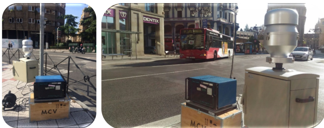
Figura 3.4. Equipamiento para la determinación del Exponente Ångström de Absorción correspondiente a una fuente “pura” de tráfico en el centro de la ciudad de León.
