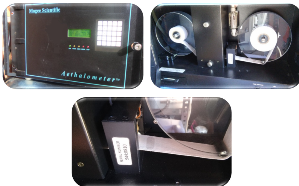
Figura 3.3. a) Etalómetro AE-31 utilizado durante la campaña de muestreo; b) Cinta de cuarzo; c) “Spot” con aerosol atmosférico muestreado.
