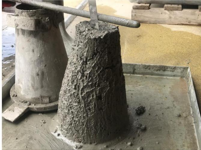
**Figura 18: Ejemplo de medición de consistencia con el cono de Abrams**
