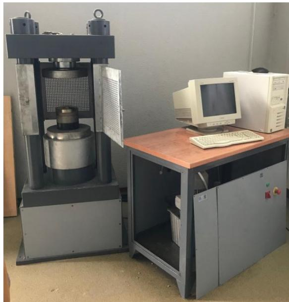
**Figura 21: Equipo empleado para ensayo de rotura a compresión**
