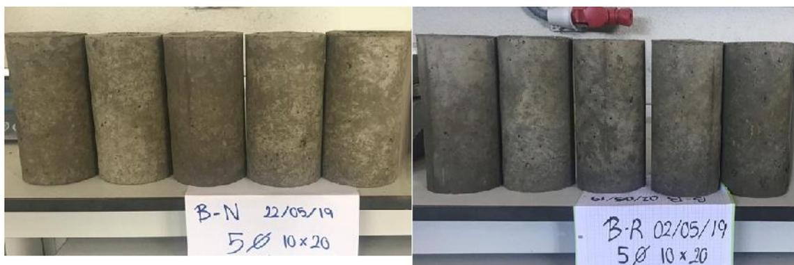
**Figura 29: Hormigón natural (izq) y reciclado (dcha) método de Bolomey**
