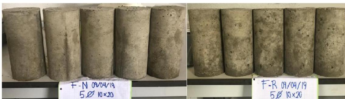
**Figura 28: Hormigón natural (izq) y reciclado (dcha) método de Fuller**
