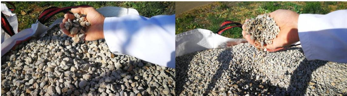
**Figura 9: Árido reciclado procedente de hormigón suministrado por Reutiliza S.L.**
