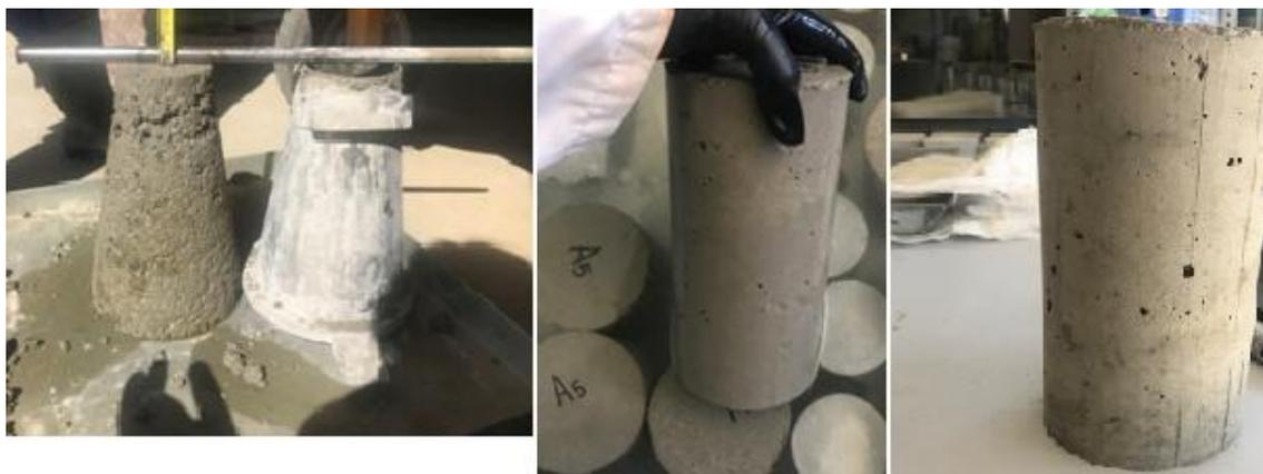
**Figura 40: Cono de Abrams y probetas Faury 3**
