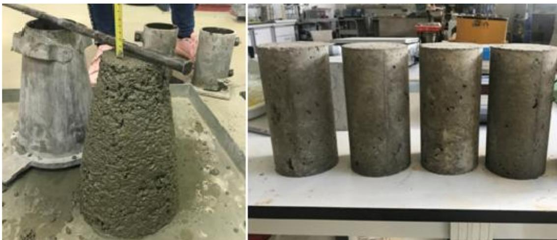
**Figura 42: Cono de Abrams y probetas hormigón de limpieza**
