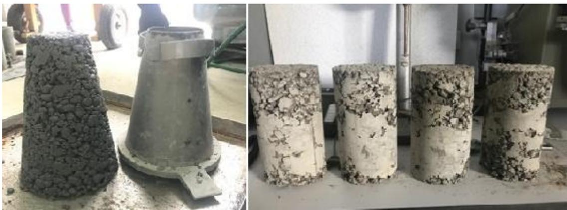
**Figura 37: Cono de Abrams y probetas método de Faury 1**
