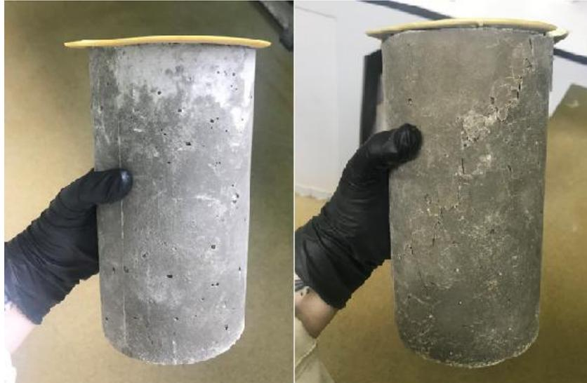
**Figura 22: Probeta antes y después del ensayo de rotura a compresión**
