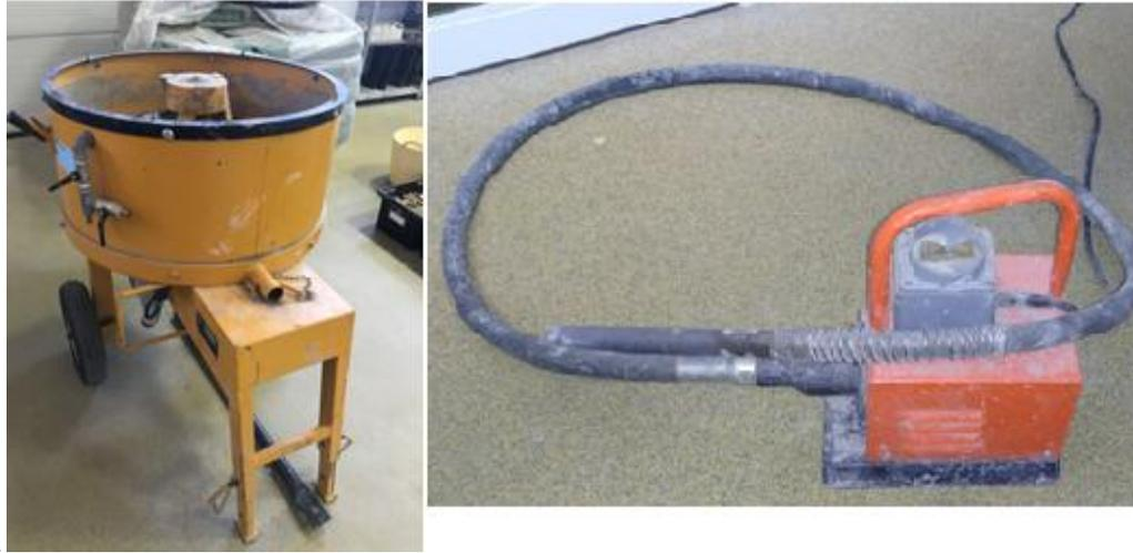
**Figura 19: Hormigonera de eje vertical (izq) y vibrador de aguja (dcha)**
