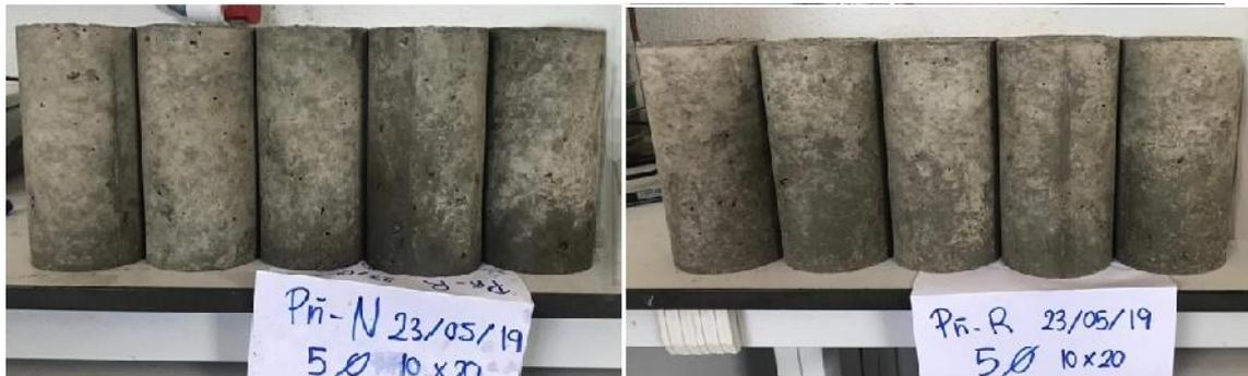
**Figura 30: Hormigón natural (izq) y reciclado (dcha) método de La Peña**
