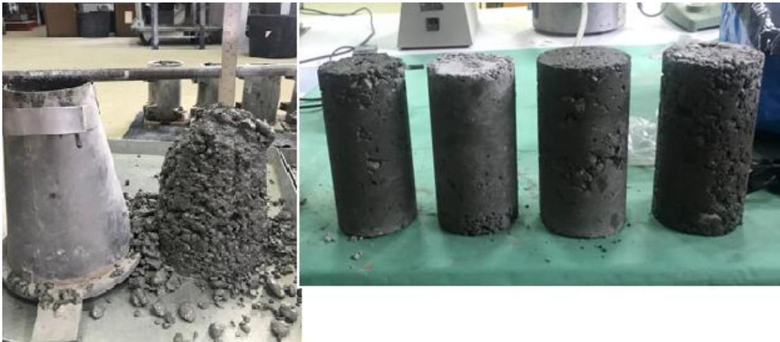
**Figura 39: Cono de Abrams y probetas Faury 2**
